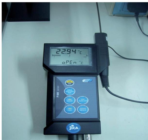
*Figura. All.11 Termómetro Termistor Omega Modelo 450-ATH*
