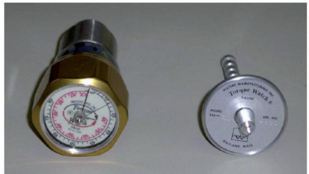
*Figura AII.7. Reloj de Torque Waters*
