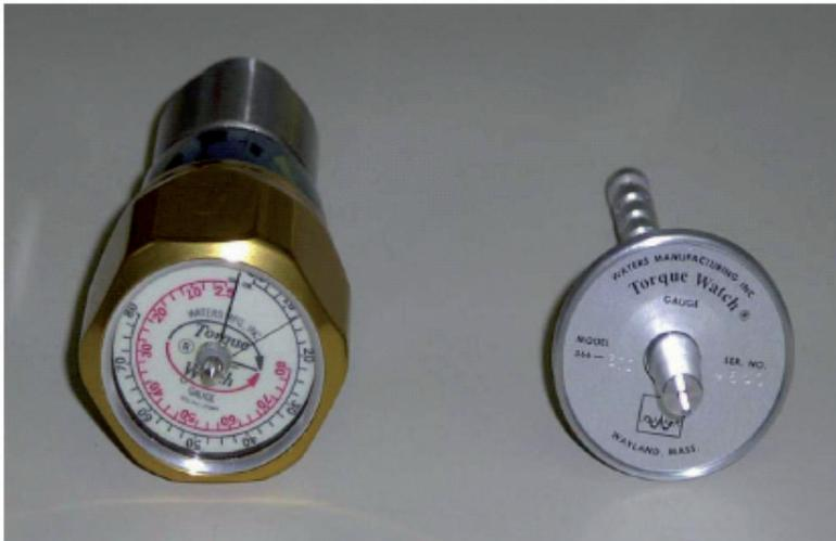
*Figura A II.3 Relojes de Torque Waters*
