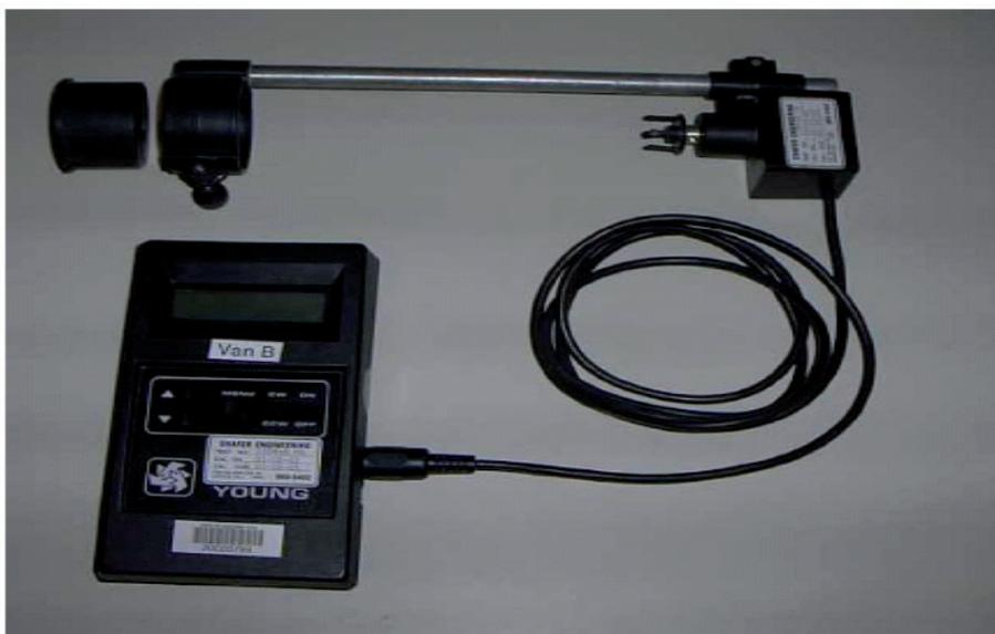
*Figura AII.1 Generador de velocidad en rpm marca R.M. Young.*
